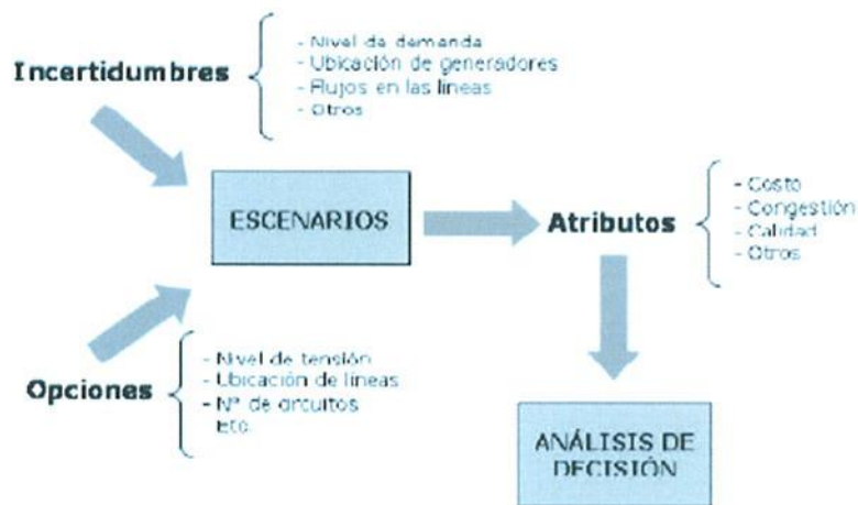
Figura 2.1. Proceso de Planificación Metodología TO/R – MINIMAX.
